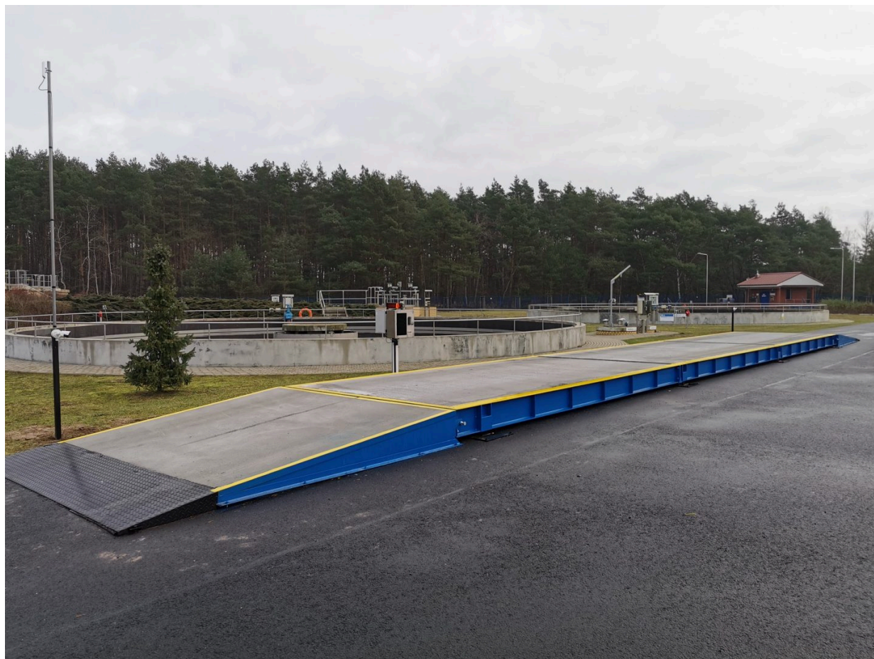
Rysunek 2: Przenośna waga najazdowa wraz z rampami dojazdowymi [źródło:[img_waga_najazdowa]]
